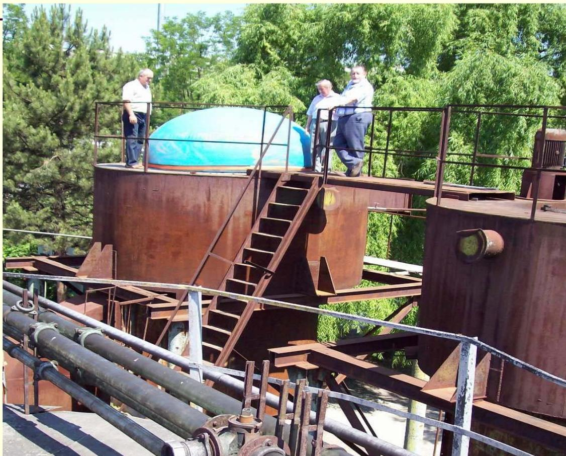
**Экспериментальный анаэробный биореактор на винзаводе Бардар**
